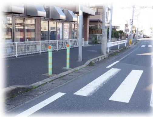
車止め（鋼製）（市道 3 7 号線）
